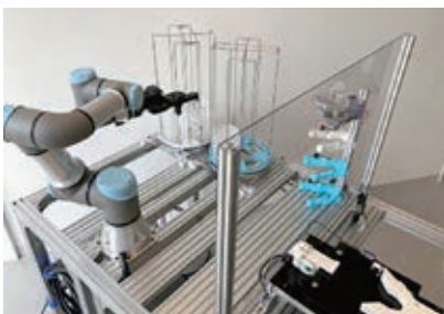
開発されたロボットハンドによるシャーレ移動の様子。(職員の作業工数削減)
